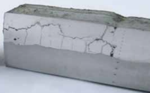
Kromkarbidbelagd plåt (CCO) 2-lagers plåt 9+10mm
